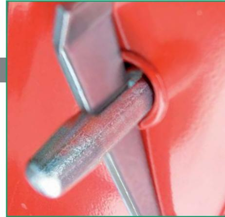
Ältere SL-Elemente sind noch mit geradem Profil gefertigt. Zur schnellen Verbindung dieser alten SL-Elemente mit XT oder AT steht eine spezielle Verbindungsklammer zur Verfügung. Sie greift ins Verbindungsloch des SL-Elements auf der einen Seite und ins Profil des XT- oder AT-Profiles auf der anderen Seite ein. Die Elemente werden dadurch fluchtend und bündig ausgerichtet und die unterschiedlichen Rahmenhöhen ausgeglichen.
