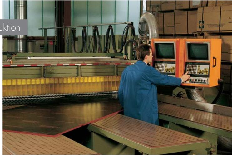
Der Zuschnitt der Rahmenteile erfolgt auf einer CNC-gesteuerten Sondermaschine. In der gleichen Einspannung wird auf Gehrung gesägt und gleichzeitig die Schweißnaht vorbereitet. Im darauf folgenden Arbeitstakt werden gleichzeitig die Spann- und Verbindungs-löcher gebohrt. Zum Schluss werden die konischen Hülsen eingepresst.
